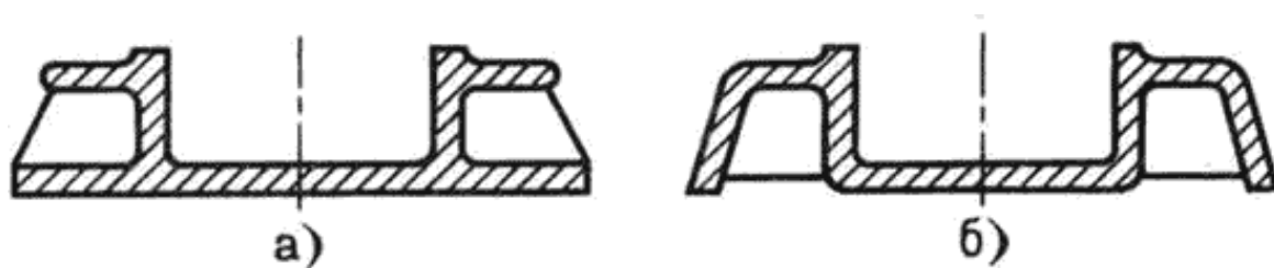
34 -сурет. Құйылған бөлшектің құрылысындағы ойықтарды жою
